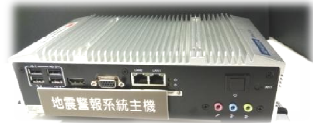
地震警報系統主機正面照
